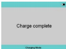
Effettuare due cicli di carica da 5 ore (tempo massimo impostato per la ricarica) per ottenere una carica completa delle batterie, in quanto sono necessarie almeno 8/10 ore.
