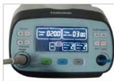
Dans le mode intermittent, il est possible de régler le temps ON (de 1 à 9 secondes) et le temps OFF (de 1 à 9 secondes) par l'utilisation des touches situées dans la partie droite de la partie frontale.
