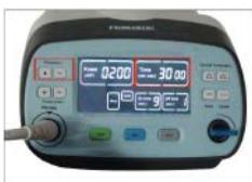
Régler l'intensité de la thérapie en appuyant sur POWER + et POWER - placé sur le côté gauche du panneau avant. La puissance est réglée par défaut à 200mW et est réglable de 10mW à 500mW en fonction de la nécessité d'un traitement.
