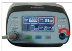
Choisir le mode de fonctionnement entre CONTINUE (continue) et CYCLE (par intermittence) en appuyant sur le bouton correspondant sur le côté droit de l'avant.
