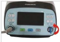
Après le traitement, éteindre l'appareil en mettant l'interrupteur à clé en position OFF.
