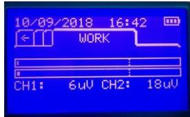
Während der TAR-Modus (Target, Keep Level) in der nachstehenden Abbildung dargestellt ist, zeigen die beiden vertikalen gepunkteten Linien das maximale und minimale Kraftniveau an, innerhalb dessen der Benutzer bleiben muss, um die Bedingung des Einhaltens des Niveaus zu erfüllen.
