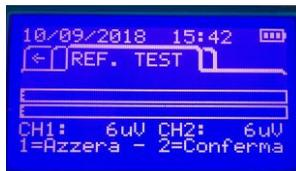
In diesem Modus muss die zu bearbeitende Referenzkontraktionsstufe erfasst werden. Wenn der gewünschte Schwellenwert erreicht ist, drücken Sie 2 zur Bestätigung und gehen Sie zum nächsten Bildschirm, andernfalls setzen Sie den Zähler durch Drücken von 1 zurück und wiederholen den Vorgang.
